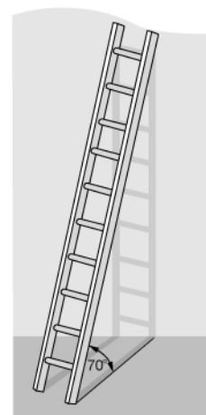
Рис. 5. Подбор соответствующего наклона лестницы – угол 70°
